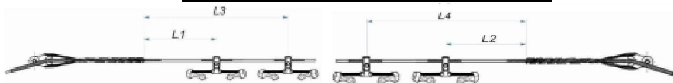
Рисунок 1. Места установки гасителей вибрации у натяжных зажимов.
